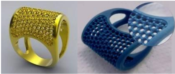
◆ Esempio di foratura e griffe per l'incassatura
